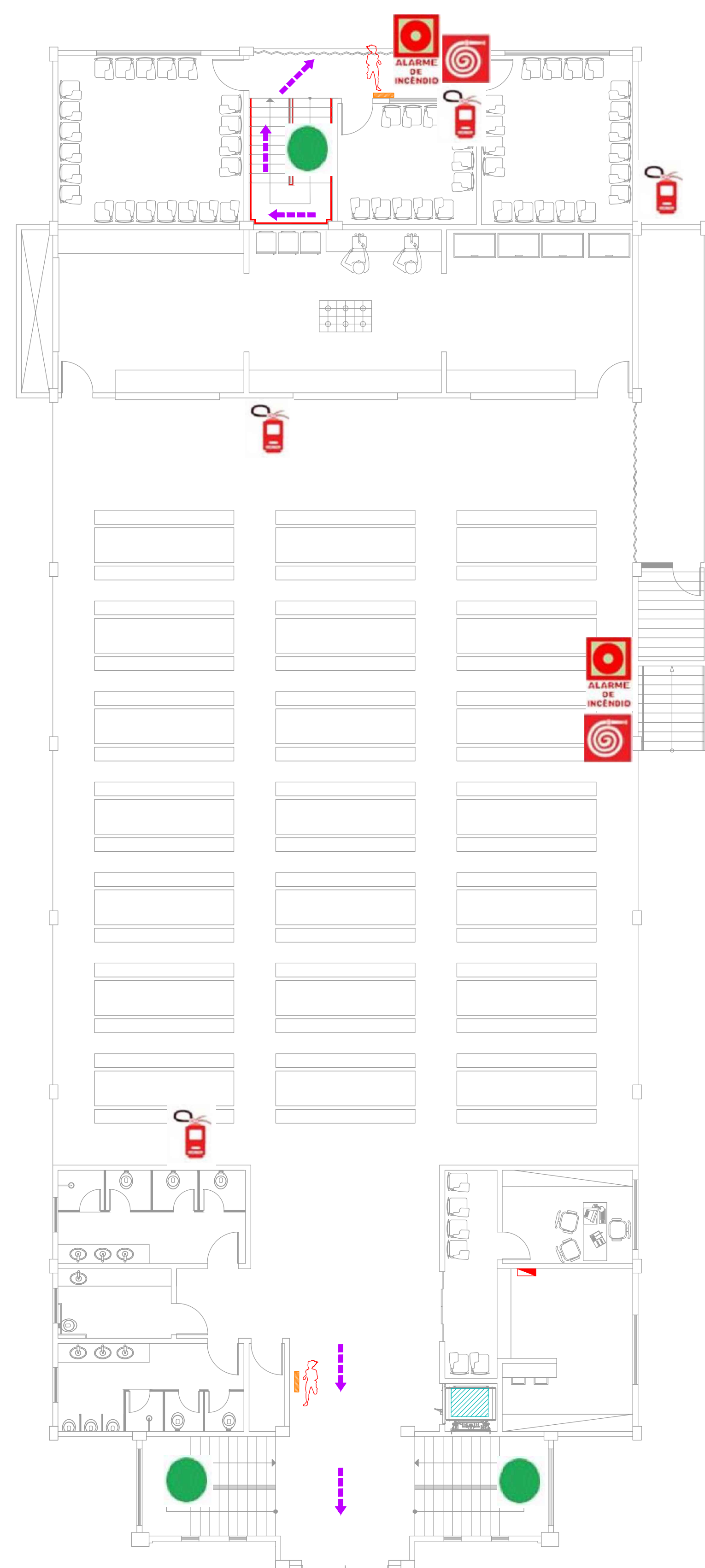
PLANTA DE EMERGÊNCIA INTERNA – TÉRREO 1/100
